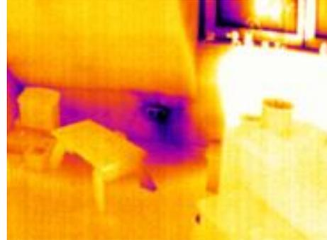
Défaut d'étanchéité autour d'une prise électrique
