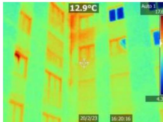
Affaissement de l'isolant dans l'angle au centre de la photo
