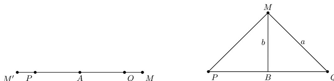
Cela permet facilement par construction à la règle et au compas de trouver  $P$  et  $Q$  connaissant  $a$  et  $b$ , ou de trouver  $a$  et  $b$  connaissant  $P$  et  $Q$  et la longueur de la corde  $c$ .
