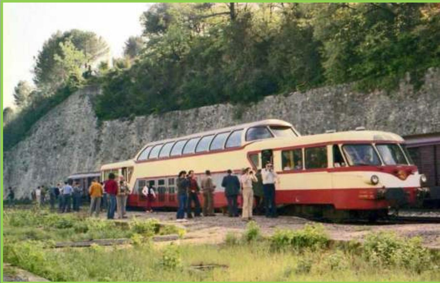
Ce modèle, en service de 1959 à 1985 fut construit à seulement 10 exemplaires dans le midi de la France. D'une longueur de 26,70 mètres, il pouvait accueillir 88 places, l'étage supérieur, dans la partie panoramique, était réservé aux 1ères classes; les sièges pouvaient pivoter.
