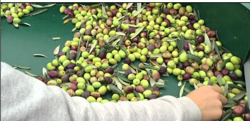
Une fois les olives cueillies, elles sont transitées au Moulin, là le Moulinier peut entamer les étapes de fabrication de l'huile. Les olives stockées dans des box après leurs cueillettes sont transférées dans la laveuse, il s'agit d'un système mécanique où les olives passent sous des jets d'eau afin qu'elles soient nettoyées de toute poussière. L'effeuillage, quant à
