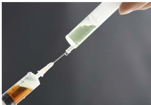
Fig. 54 : Passage du dioxyde de chlore gazeux dans une solution saline à l'aide de seringues
