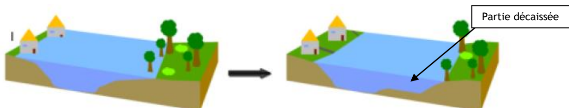
Schéma de principe d'une protection localisée de type « décaissement »
