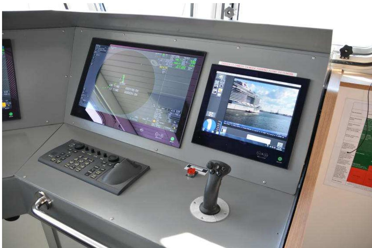
*Répéteur radar et poste de contrôle du Vigy Observer (© MER ET MARINE - VINCENT GROIZELEAU)*
