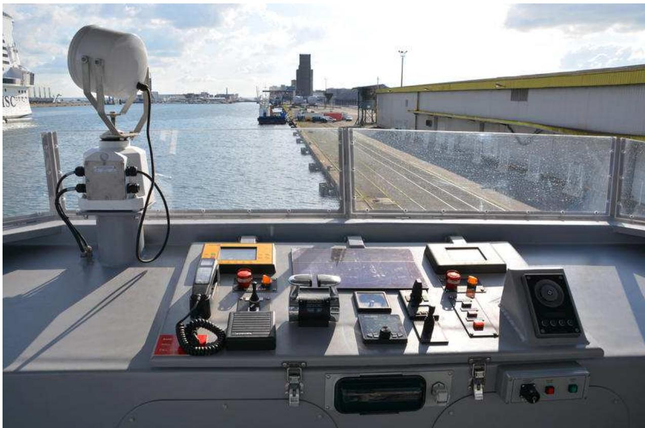
*Le poste de conduite extérieur situé sur le fly deck (© MER ET MARINE - VINCENT GROIZELEAU)*
