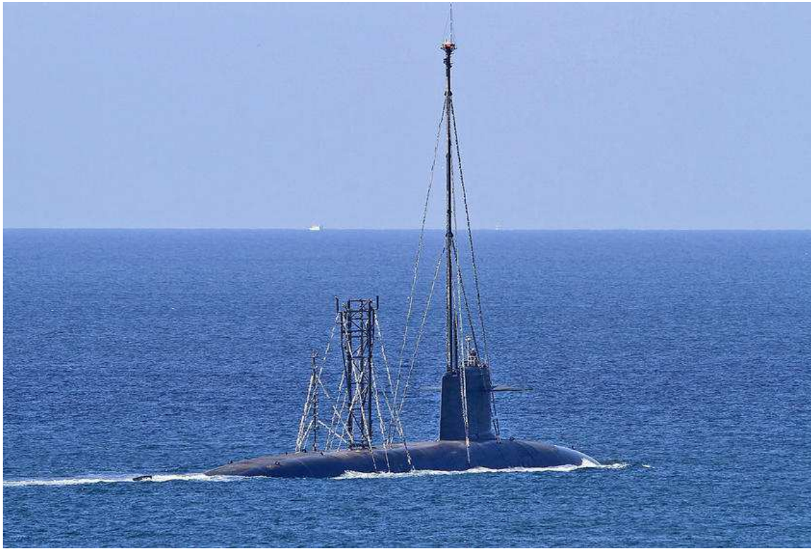
Le Téméraire sortant de Brest avec les équipements d'essais sur le pont, notamment le mât de liaison (© : MICHEL FLOCH)
