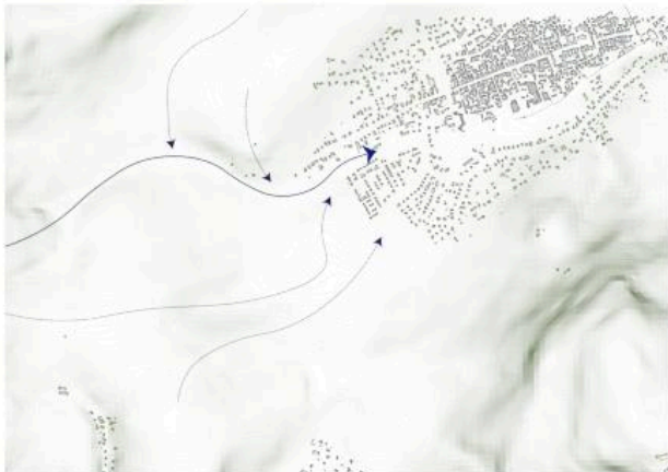
CONSTAT DE L'ÉCOULEMENT DES EAUX SELON LA TOPOGRAPHIE
