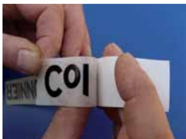
Séparer avec prudence, du support papier le texte sous transfert. Aucune lettre ou ponctuation, ou point du « i » ne doit rester adhérente au papier support !
