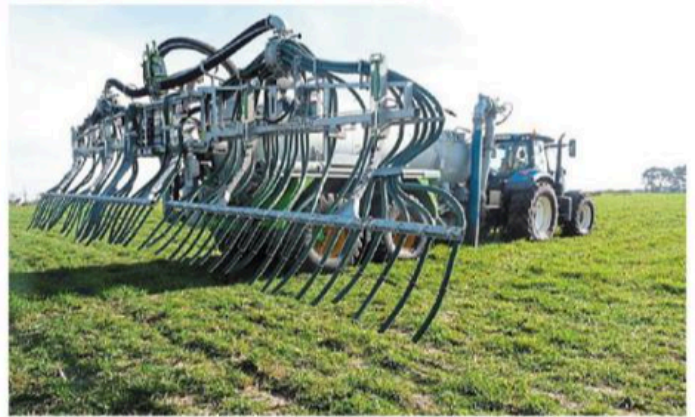
Cette rampe à pendillards permet de réduire de 30 à 50 % les émissions d'ammoniac lors des épandages par rapport aux traditionnelles buses palettes.
