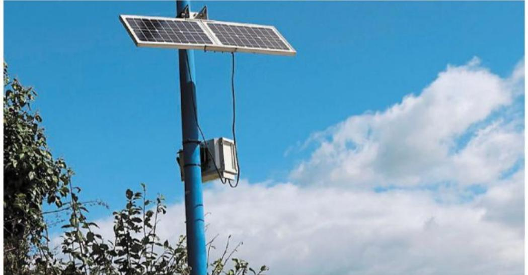
Un capteur d'hydrogène sulfuré à la plage du Valais, à Saint-Brieuc (Côtes-d'Armor).
