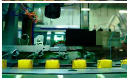
Pour finir, le bouchon est placé sur chaque bouteille au sein d'une chambre stérile et toujours sous vide. Les bouteilles de pulpe sont alors prêtes à être distribuées à travers le monde.
