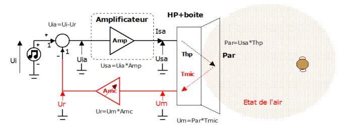
Malheureusement, la tension  $U_m$  n'est pas accessible à partir de bornes spécialisées du HP. Même s'il vient à l'idée d'utiliser l'une des bobines des deux que possèdent certains HP. Cette solution ne fonctionne pas correctement à cause de la mutuelle induction qui règne entre les deux bobines
