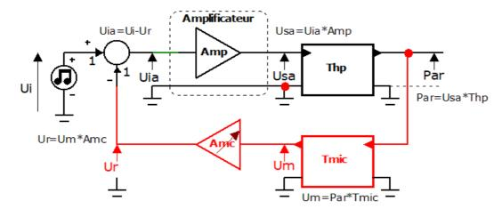
Cela ne nous apportera pas grand chose vis à vis du fonctionnement de l'ensemble, mais à l'avantage de montrer la démarche à suivre pour la mise en équation d'un système bouclé.
