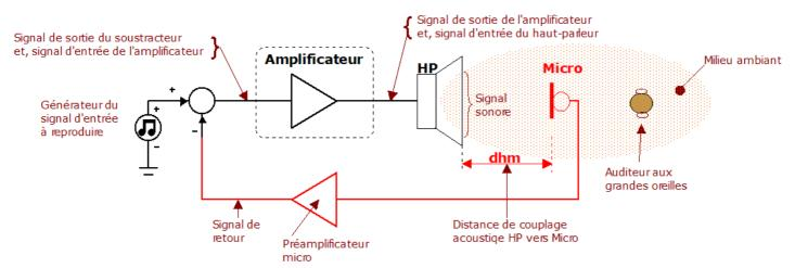
Le HP est placé dans une enceinte close, dont les parois sont supposées parfaitement rigide. Cela permet de ne considérer que la pression acoustique délivrée par la face avant de sa membrane, en contact aérien avec le milieu ambiant, et dans lequel se trouve l'auditeur. Les difficultés pour parvenir à un résultat satisfaisant sont principalement dues :
