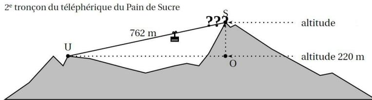
Sur la figure ci-dessus, qui n'est pas à l'échelle, les directions (UO) et (SO) forment un angle droit et l'angle  $\widehat{OUS}$  que forme le câble du téléphérique avec l'horizontale mesure  $13,35^\circ$ .
