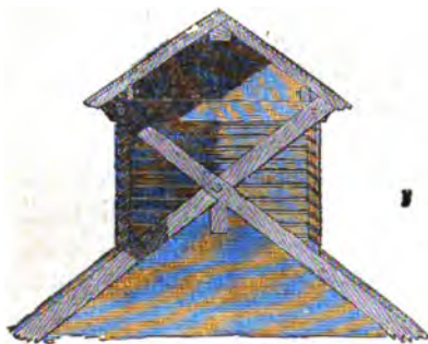
Fig. 13. — Coupe du pavillon ventilateur.
