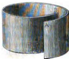
Fig. 41. — Feuille de bois pour faire des moules à fromage.
