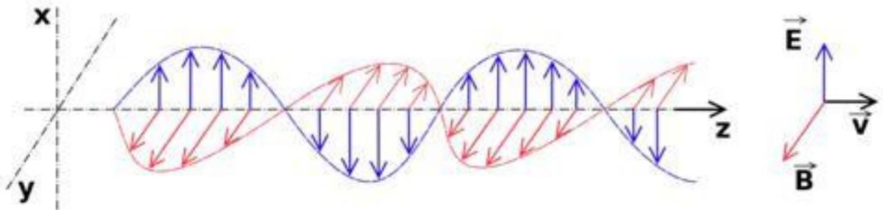
*E : champ électrique, B : champ magnétique. V : direction de l'onde électromagnétique.*
