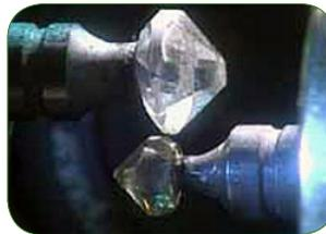
**Le débrutage** permet, grâce à un autre diamant, de donner à la pierre une forme approchant de la celle que l'on veut obtenir à la fin.
