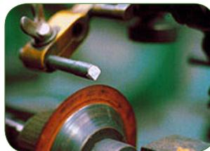
**Le sciage** consiste à découper un diamant brut à l'aide d'un disque diamanté ou d'un laser.
