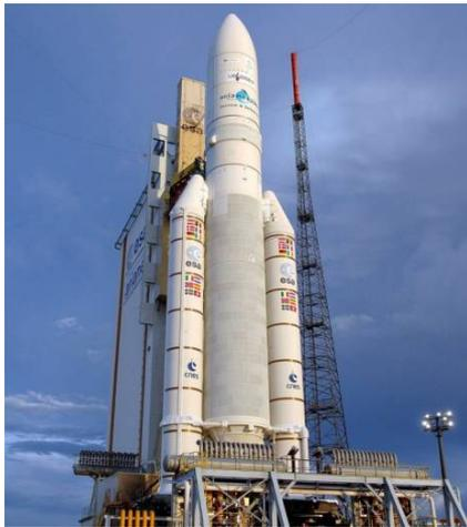
Une fusée, en astronautique, est un véhicule qui se déplace dans l'espace grâce à un moteur-fusée en emportant à la fois le combustible et le comburant nécessaires à son fonctionnement. Une fusée comprend plusieurs étages pour maximiser sa capacité d'emport. Les plus grosses fusées construites, comme Saturn V, permettent de placer jusqu'à 150 tonnes en orbite basse. Sur la photo, la fusée Ariane, fusée européenne.
