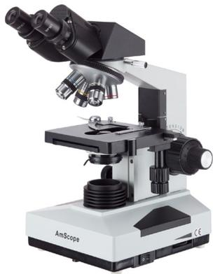
Un **microscope** est un instrument qui permet d'observer l'infiniment petit, tels les microbes, grâce à un système de lentilles optiques.
