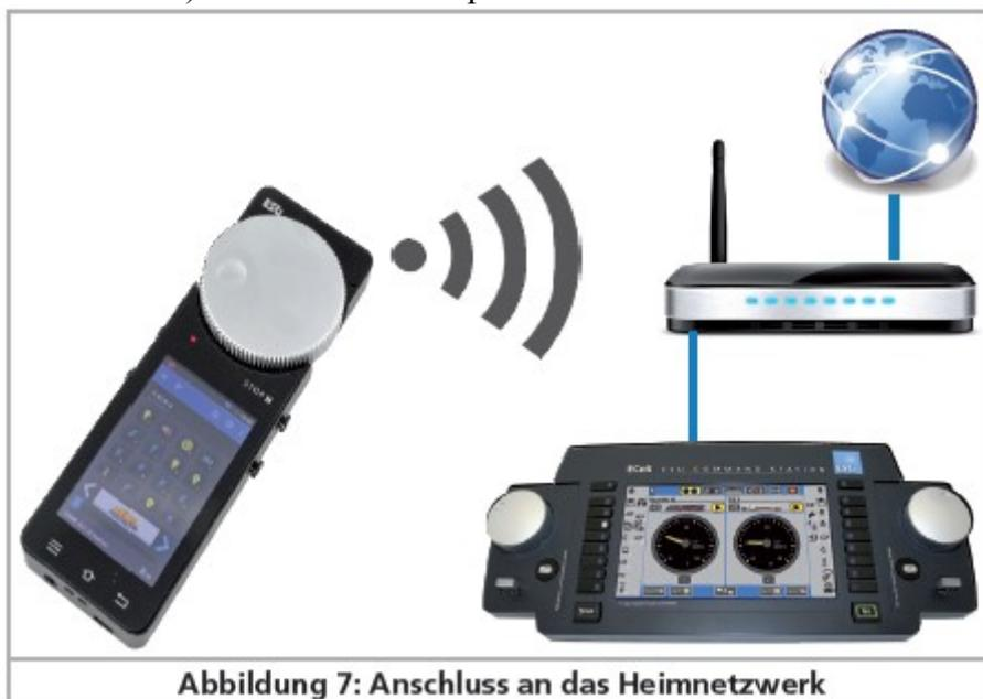
*Illustration 7 : raccordement au réseau domestique.*
