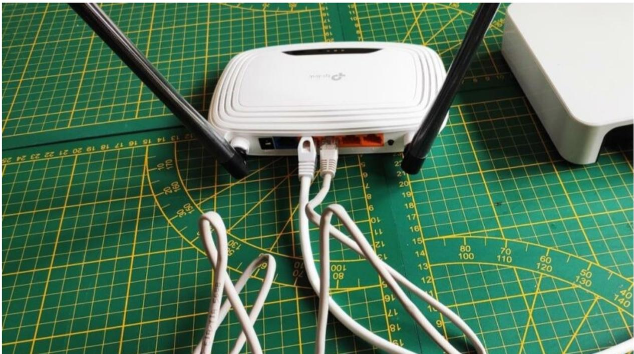
Les 2 câbles réseau (Ethernet) sont branchés sur les ports orange de la z21.
