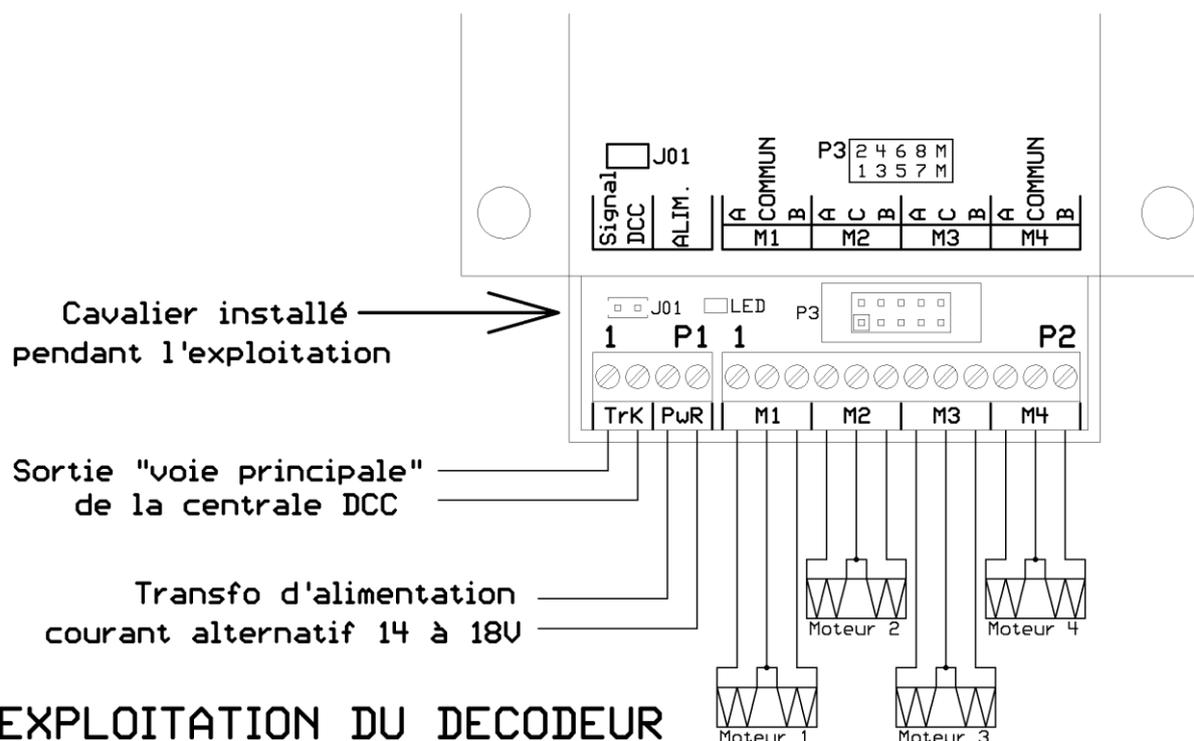
Lors de la mise en service du décodeur, celui-ci devra être relié à la sortie « voie principale » de la centrale DCC pour recevoir les instructions (bornes 1 et 2 du connecteur P1), ainsi qu'à un transformateur d'alimentation délivrant une tension alternative de 14 à 18V (bornes 3 et 4 du connecteur P1). On vérifiera que le cavalier de protection J01 a bien été remis en place. Enfin les 4 moteurs seront reliés aux bornes du connecteur P2.
