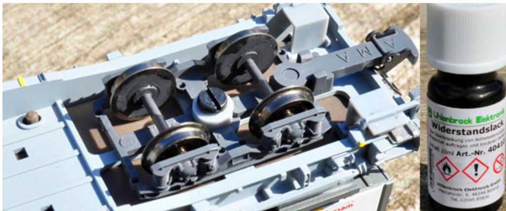
Pour les wagons, sans décodeur et sans éclairage généralement, il faut donc créer artificiellement une consommation ! Un presque "court-circuit" ! Pour cela on dispose une couche de graphite sur le moyeu en plastique, isolant les roues de l'essieu, qui fera "fuir" les quelques milli-ampères nécessaires pour rendre cet essieu détectable. On trouve ce produit prêt à l'emploi chez [Uhlenbrock](#) par exemple.
