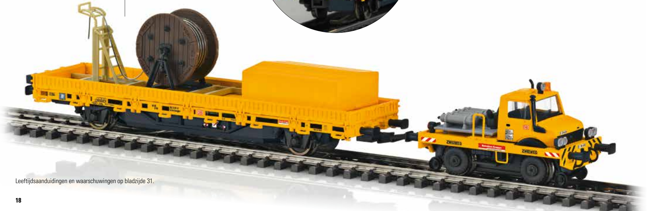
Bovenleidingbouwwagen met sluitseinen
