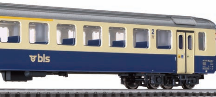
AB 50 63 30-33 816-7, mit Gummiwulst, Außenschwing- türen, Federpuffer, LüP 272 mm.
