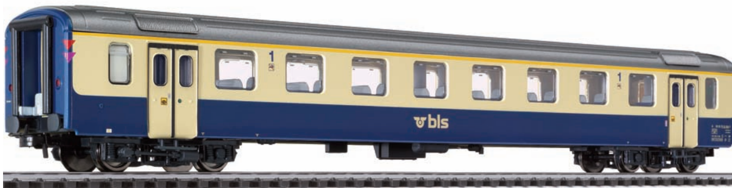
L334975 Personenwagen EW I, 1. Klasse, BLS, Epoche V/VI A 50 63 18-33 800-7, mit Gummiwulst, Außenschwingt- türen, Federpuffer, LüP 272 mm.
