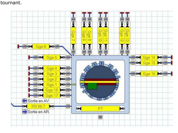
Une fois le TCO réalisé, les cantons positionnés, ces derniers nommés de façon simple, claire et précise, placer des boutons à chaque extrémités des cantons, et 1 seul bouton autour du pont.
