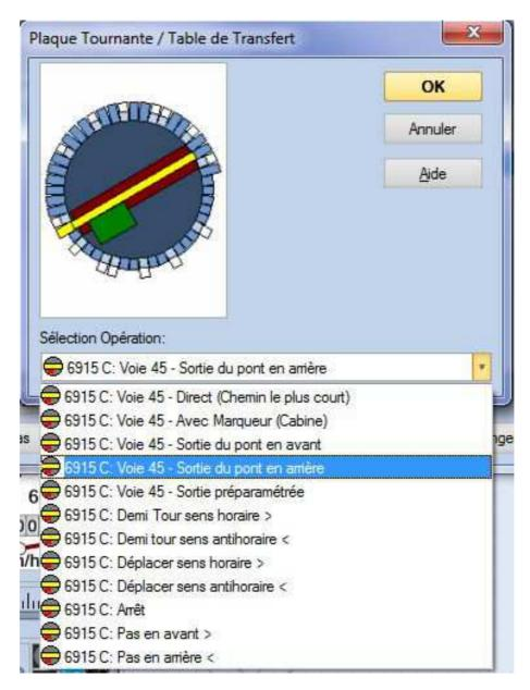
C'est les boutons poussoirs qui déterminent quel trajet sera lancé. L'orientation de la cabine sur la figure n'a pas d'importance. TC orientera le pont afin que la loco sorte en marche arrière.
