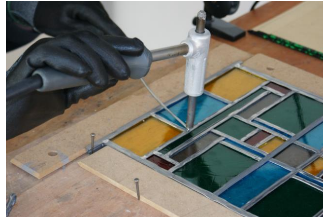
Technique du vitrail, soudure
