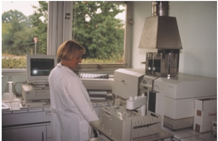
Appareil d'analyse physico-chimique, informatique associée et desserte dans un laboratoire de contrôle (à noter le dispositif d'extraction localisée)
