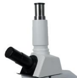
Duo head or « discussion », rotated 360°, inclined at 30°
