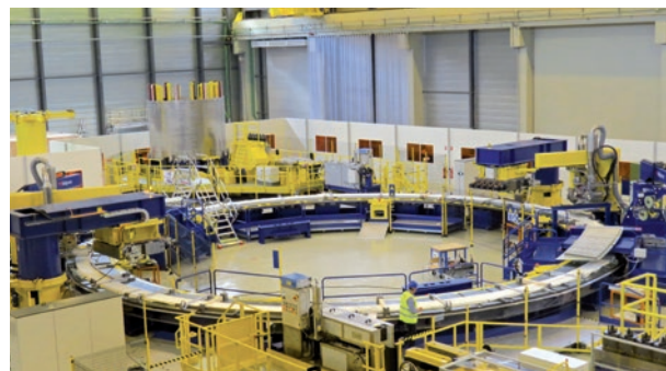
A terme, sept tables de bobinage comme celle-ci permettront de réaliser les bobines qui produiront un puissant champ magnétique.
