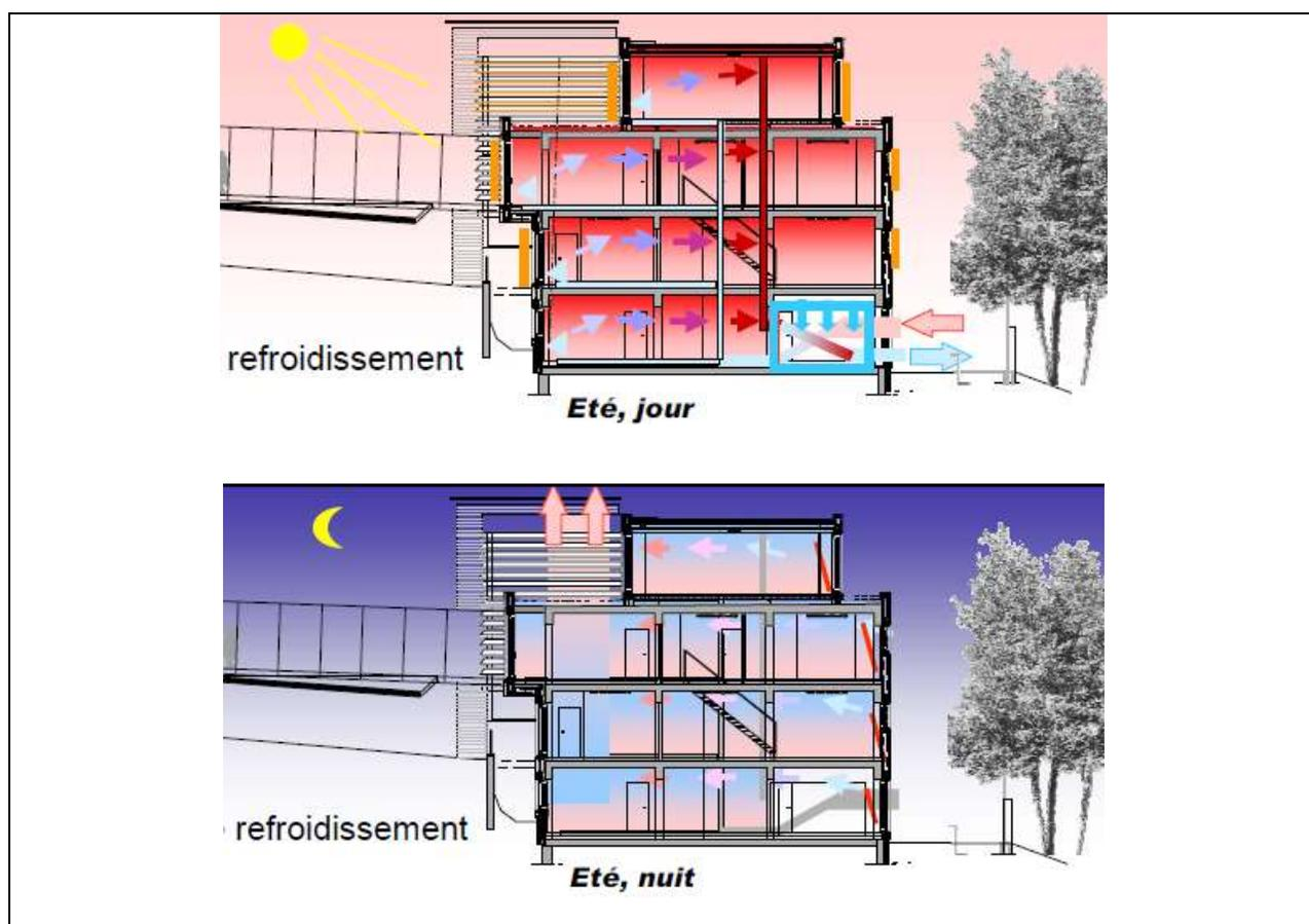
**Figure 23 :** Système de ventilation basé sur la masse thermique, la ventilation naturelle et les variations de température entre le jour et la nuit
