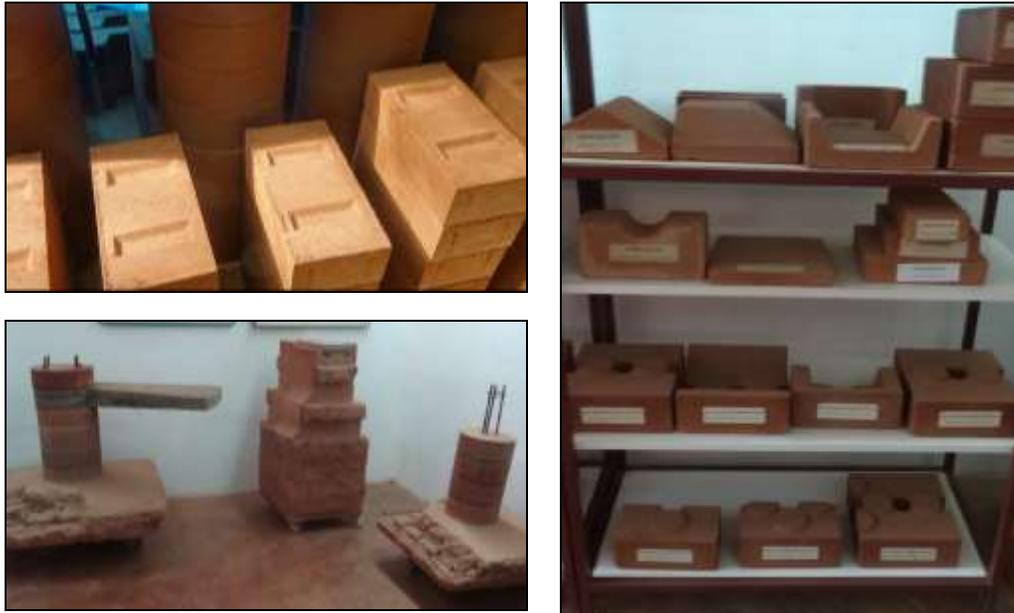
**Figure 39** : Exemples de différents types de blocs de terre compressée et stabilisée
