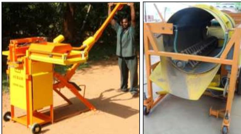
**Figure 40**: Exemples de presse à main et de presse motorisée
