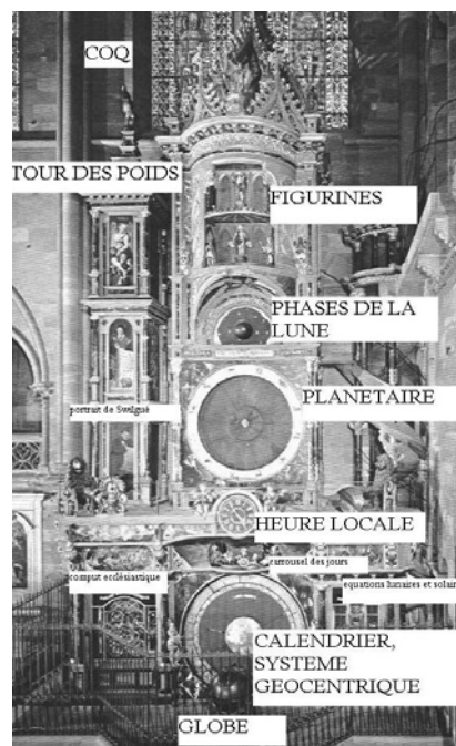
FIGURE 3 : Photographie de l'horloge montrant les différents éléments (photo tiré de la brochure de R. Lehni, éd. La goélette).
