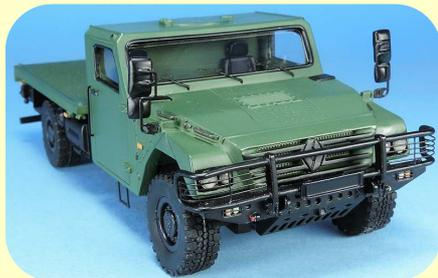
**-le Sherpa Light Carrier :** version utilitaire/cargo pouvant transporter jusqu'à 4,5 tonnes de charge utile, y compris un shelter de 10 pieds.
