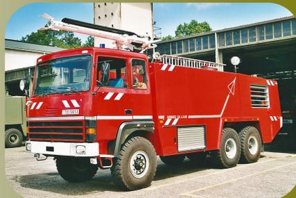
Le propre d'un engin d'extinction d'aéronefs est de pouvoir actionner sa lance-canon tout en roulant de manière à recouvrir le feu de mousse pour l'étouffer. Pour cela, la transmission du VMA 72 est équipée d'un système dit «répartiteur modulateur de puissance à gestion électronique» permettant au véhicule de se déplacer à 30 km/h tout en faisant fonctionner sa lance-canon.
