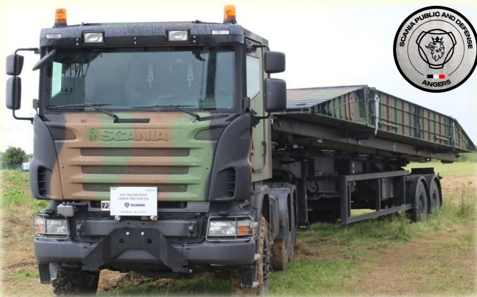
Porte-Travures Supplémentaires (PTS) sur Scania R580, 6 roues motrices, avec cabine blindée (photo Jérôme Hadacek)
