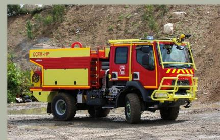
En plus de sa pompe SIDES SB 15-2000, il est équipé d'une pompe indépendante Haute Pression 400l/min 40bars permettant une économie d'eau et facilitant les interventions en milieu à fort dénivelé.
