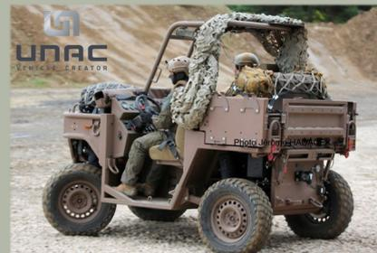
Robuste et fiable, le Fardier a été conçu sans aucun système électronique pour éviter toute panne non-réparable en opération.
