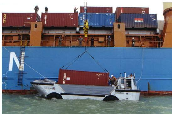
Le LARC s'est révélé être l'engin amphibie par excellence pour le transbordement maritime. Tout terrain, polyvalent, projetable, il répond pleinement aux besoins de transport de conteneurs, de personnel ou de véhicules dans son cadre d'emploi le plus dimensionnant qu'est le déchargement d'un navire en rade.
