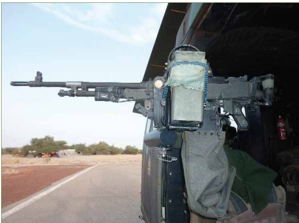
La remplaçante de l'ANF-1, la MAG 58, ici à bord du SA 330 n° 1107. (Photo F. Saint-Arroman)
