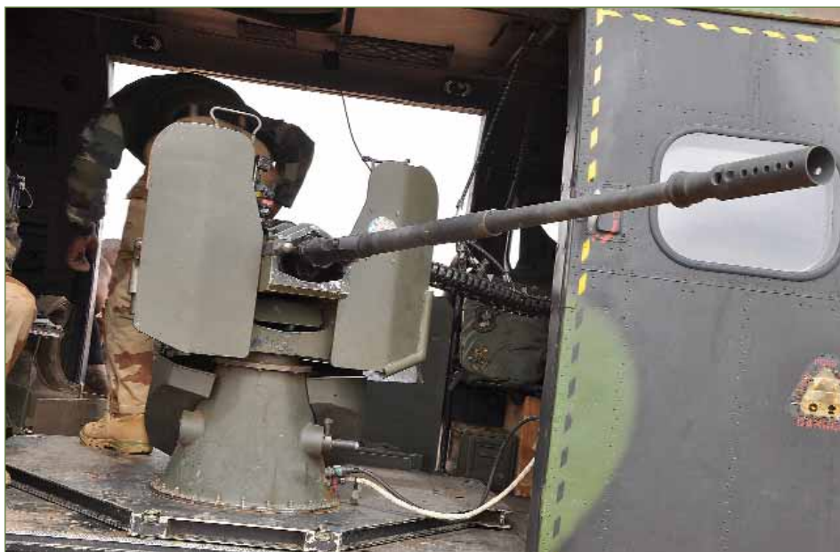
Gros plans sur le canon de 20 mm M621. (Photo F. Saint-Arroman)
