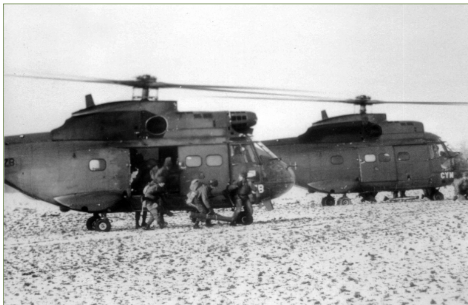
Le grand marchepied, rajouté au début de la carrière du Puma dans l'Alat, facilite grandement les embarquements et débarquements des soldats équipés, comme ici en 1983. (archives 1 er RHC)
