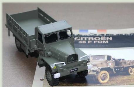
**Caractéristiques techniques :** Poids à vide : 6,3 t ; charge utile : 2,6 t ; longueur : 7,010 m ; largeur : 2,420 m ; Hauteur : 3,100 m ramenée à 2,190 m bâche déposée et pare-brise rabattu ; direction assistée ; moteur essence, 6 cylindres Citroën P 38 de 97 cv ; vitesse : 71 km/h ; autonomie : 350 km et 630 km avec 6 jerricans de 20 litres.
