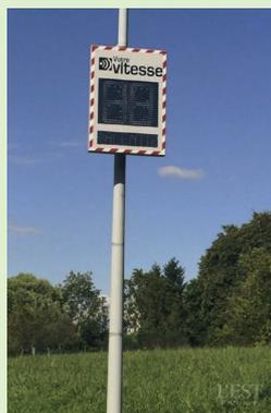
Depuis peu, deux cinémomètres du type Previom ont été installés sur la commune. Un appareil a été implanté sur la RD79, avenue Victor-Hugo au niveau de la rue Charles Pique et un autre avenue Pasteur, au niveau de l'allée des Roches Mauban, où la circulation est réglementée à 50 km/h.
