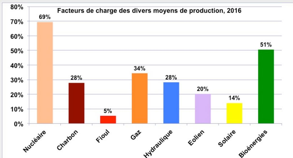
Facteurs de charge de chaque moyen utilisé en France en 2016. Ce facteur représente le « pourcentage moyen de la puissance utilisée ». Ainsi, pour le fioul, sa production à la fin de l'année est la même que si il était constamment réglé pour produire à 5% de sa puissance installée (qui est de 7,14 GW à fin 2016) toute l'année.
