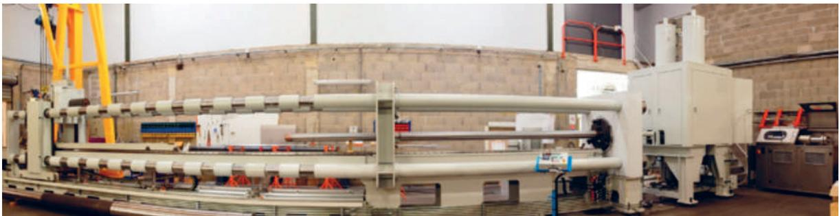
Machine d'autofrettage de tubes d'armes de moyens et gros calibres
