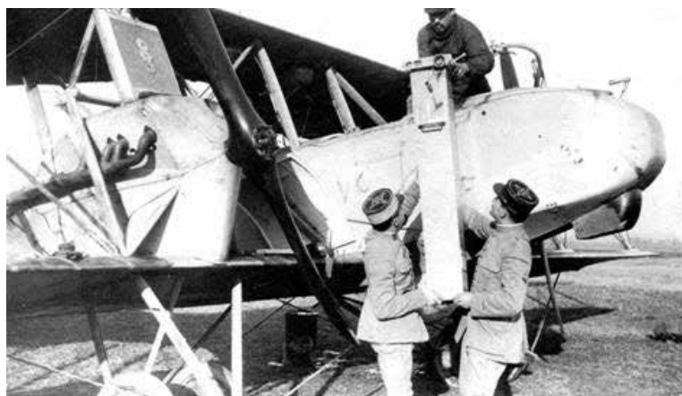
Letord 12 avec un appareil de prises de vues verticales à grande focale, SHD.
