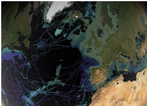
Fig.1 Etat des mesures précises de la topographie des fonds marins, réalisées au sondeur acoustique, en Atlantique Nord : aucune donnée publique n'est disponible dans les zones en noir (© GEBCO-Shom)
