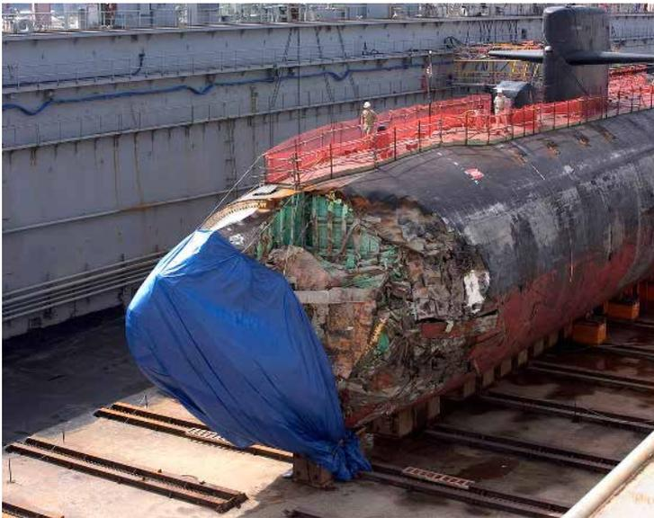
Fig. 2 : Le sous-marin USS San Francisco (SSN-711) en cale sèche après une collision avec un mont sous-marin non répertorié au sud de Guam en 2005 (©US Navy)
