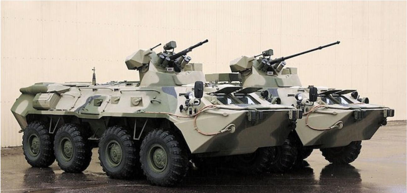
A gauche **BTR-82** Mitrailleuse KPVT 14.5 mm à droite **BTR-82A** Canon 2A72 de 30 mm
