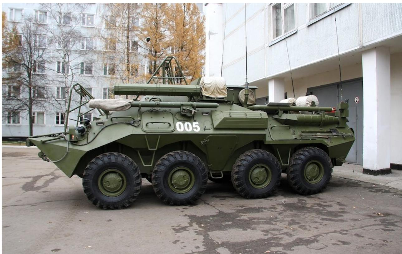
Une station de radio mobile P-166-0.5 a été identifiée pour la première fois dans les régions déchirées par la guerre de Lougansk et de Donetsk. Ce système de communication a été installé par l'armée russe sur un châssis de véhicule **BTR-80 K1sh1** modifié pour une meilleure protection au combat.
