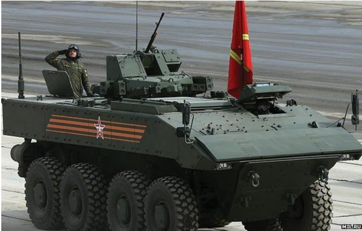
Le projet est connu sous le nom de Bumerang (boomerang). Ce véhicule de base est un véhicule blindé de transport de troupes. Il est développé aux côtés d'une famille de **véhicules blindés à chenilles Kurganets** de nouvelle génération.
