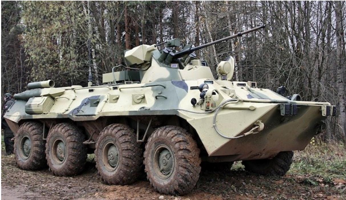
Le **BTR-82A**, est la dernière version disposant d'un blindage renforcé, d'un système de vision nocturne TKN-4GA-02, d'un système de navigation GLONASS et d'un moteur de 300 ch. Il est *armé d'un canon de 30 mm et d'une mitrailleuse coaxiale de 7,62 mm*. Il a été adopté par l'armée russe en 2013. Cet APC a été exporté vers l'Azerbaïdjan, le Biélorussie, le Kazakhstan et la Syrie.
