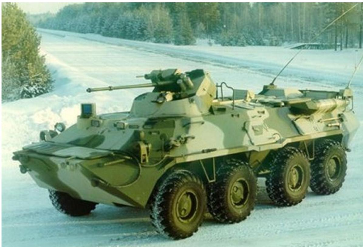
Le véhicule blindé de reconnaissance BRDM-3 est destiné à opérer jusqu'à **120 km** derrière les lignes ennemies. Il est basé sur le véhicule blindé de transport de troupes BTR-80A. Certaines sources font référence à tort au nom de la variante de transporteur ATGM du BRDM-2.
