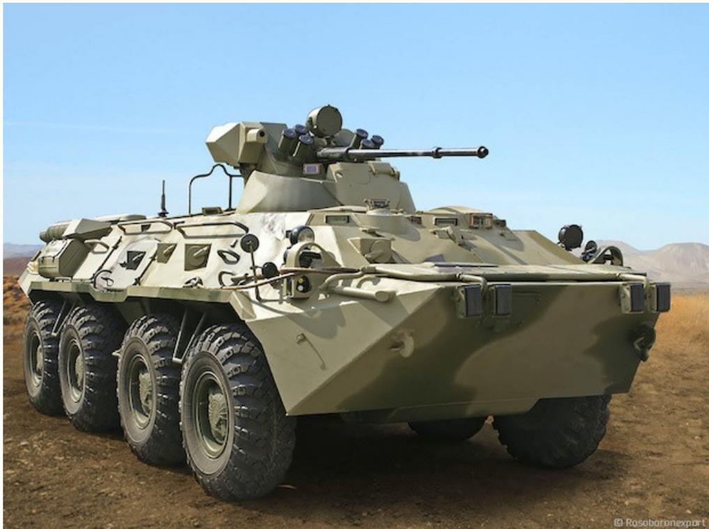
**BTR-80AK** - Variante pour le commandement du BTR-80A avec *deux antennes* dans les coins arrière et avec seulement un poste de tir sur le côté droit de la coque.
