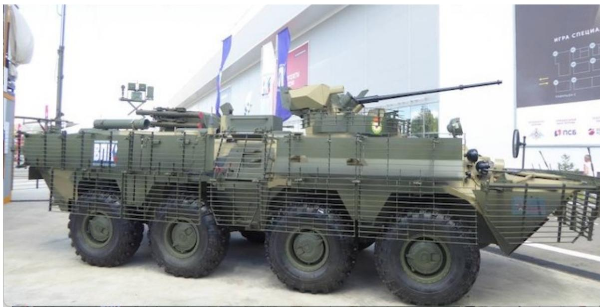
Le BTR-82AT est un véhicule blindé de combat amphibie à roues pour mener des combats à partir d'un véhicule. L'augmentation de la puissance de feu est obtenue grâce à *l'installation du module de combat unifié avec les commandes électriques et le stabilisateur numérique à deux plans de l'arme*
