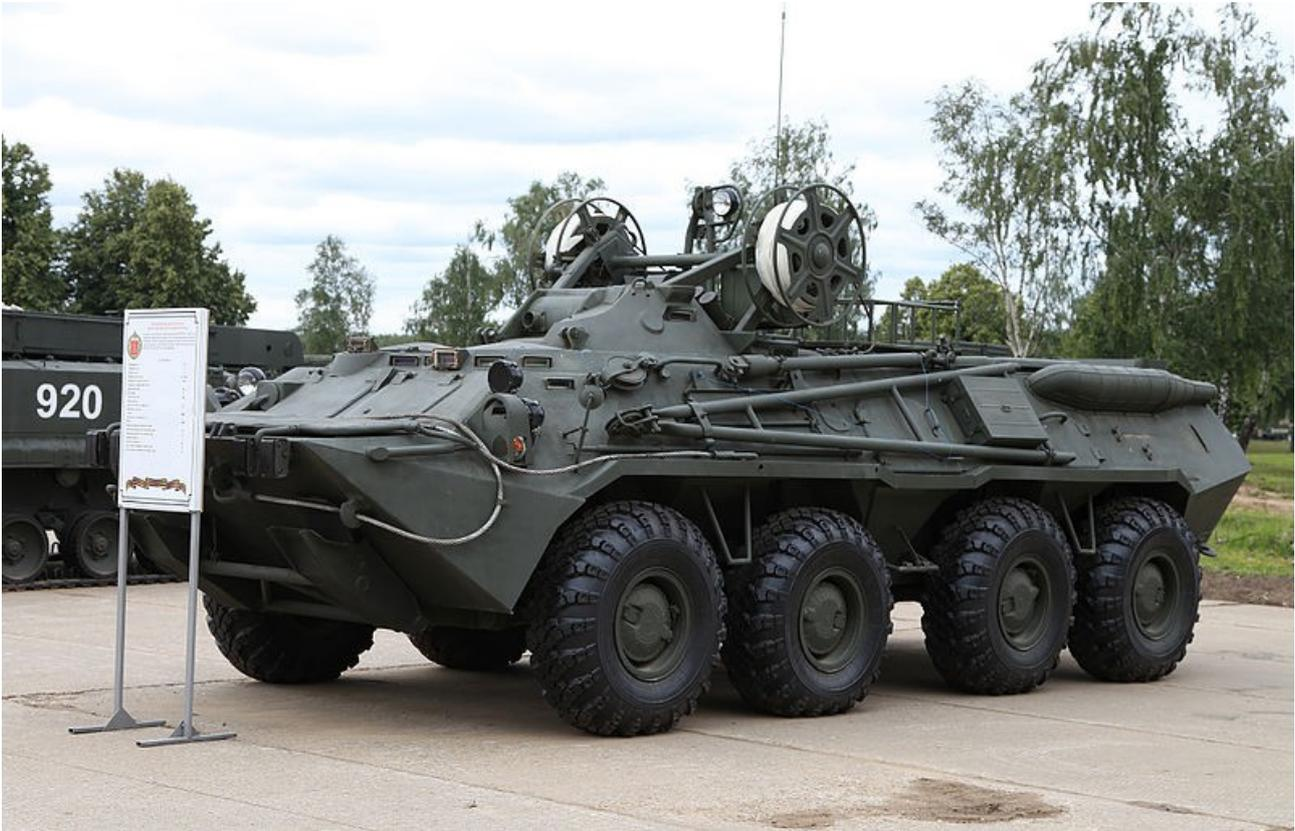
Le **BREM-K** entré en service en **1993**, est un véhicule blindé à roues de dépannage basé sur le châssis du BTR-80.
