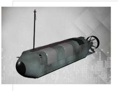
Pour les mines placées à faible immersion, la phase de destruction peut être réalisée par des plongeurs démineurs amenés près des mines par un **véhicule de transport sous-marin discret (Swimmer Delivery Vehicle)**. Les plongeurs peuvent placer, près des mines, des charges explosives munies de mise à feu qui seraient activées par une commande acoustique.
