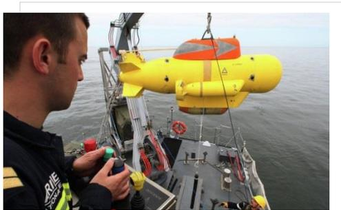
Ceci a conduit à imaginer les **sonars de chasses aux mines** et les **sonars remorqués de surveillance** pour la détection de ces menaces mais également à inventer le concept du **Poisson Auto Propulsé (PAP)**, véhicule téléguidé permettant d'identifier et de déposer une charge explosive près d'une mine, même dans des conditions environnementales difficiles.
