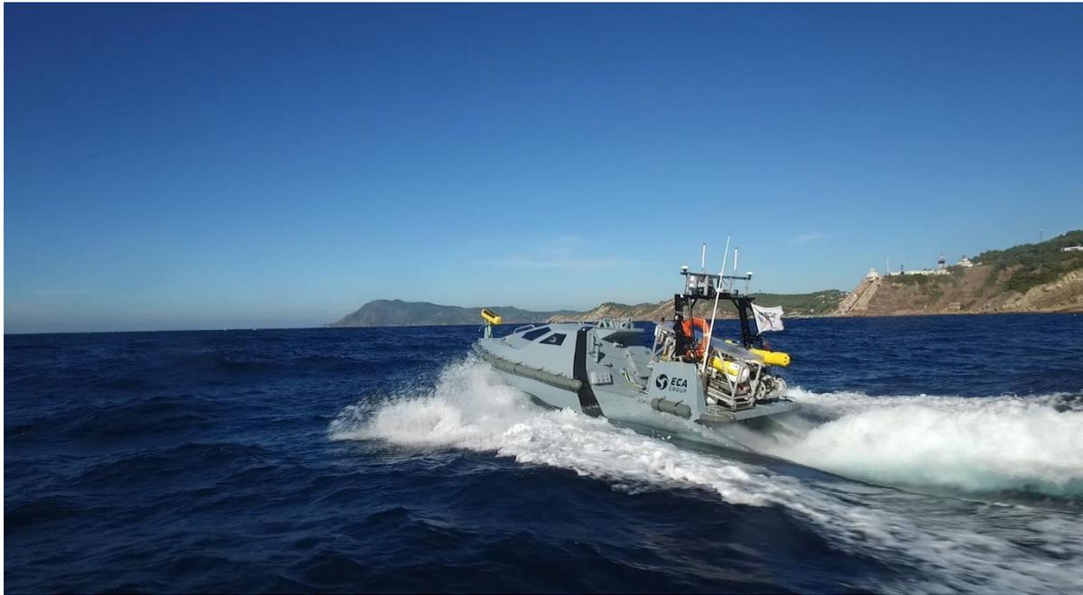
Le système de robots UMIS d'ECA Group - Unmanned Maritime Integrated System
