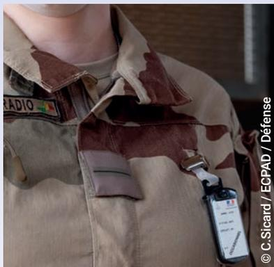
*Dosimètre passif porté par un manipulateur en électroradiologie projeté en opération.*
