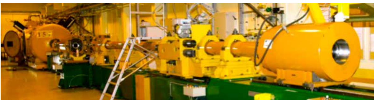
Lanceur à poudre pour l'essai dynamique de projectiles
