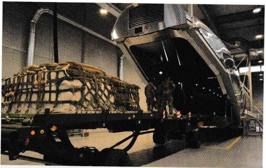
Simulateur de chargement pour un largage par gravité
